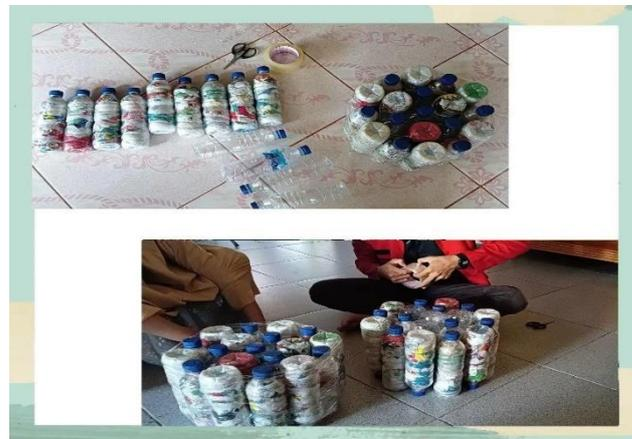
Gambar 5: Proses menyatukan botol untuk ecobrick bangku
