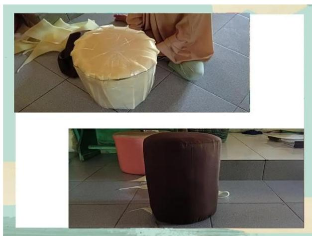
*Gambar 6: Proses pemasangan busa dan sarung untuk ecobrick bangku*
